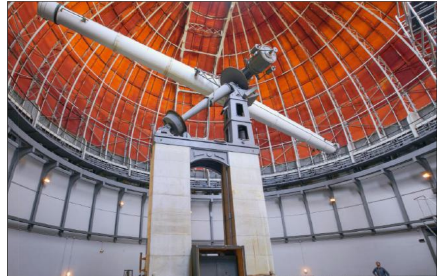
Lunettes astronomique de l'observatoire de Nice, mise en service en 1887, sous une coupole construite par Gustave Eiffel. Son grossissement peut atteindre 2 250.
