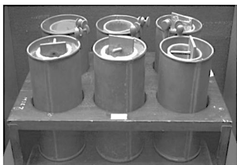
Figure 5. Photographie d'une batterie de piles Daniell
