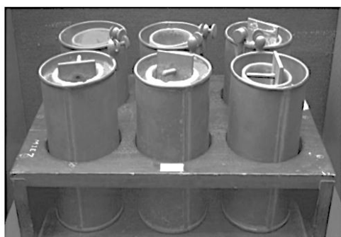
Figure 5. Photographie d'une batterie de piles Daniell
