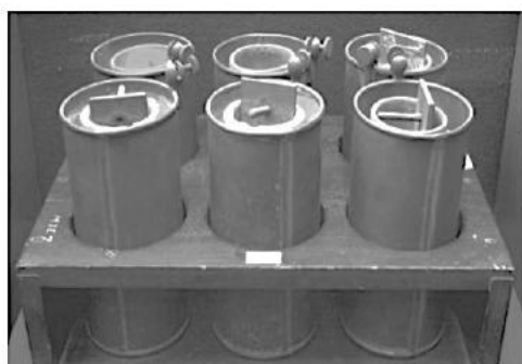
Figure 5. Photographie d'une batterie de piles Daniell
