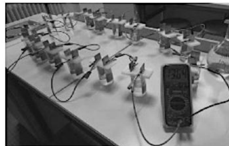
Figure 3. Photographie du montage expérimental reconstituant la superposition de 16 cellules élémentaires
