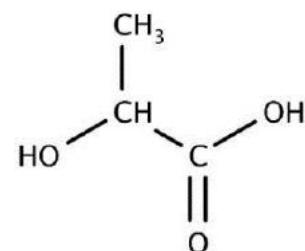
Figure 1. Formule semi-développée de l'acide lactique
